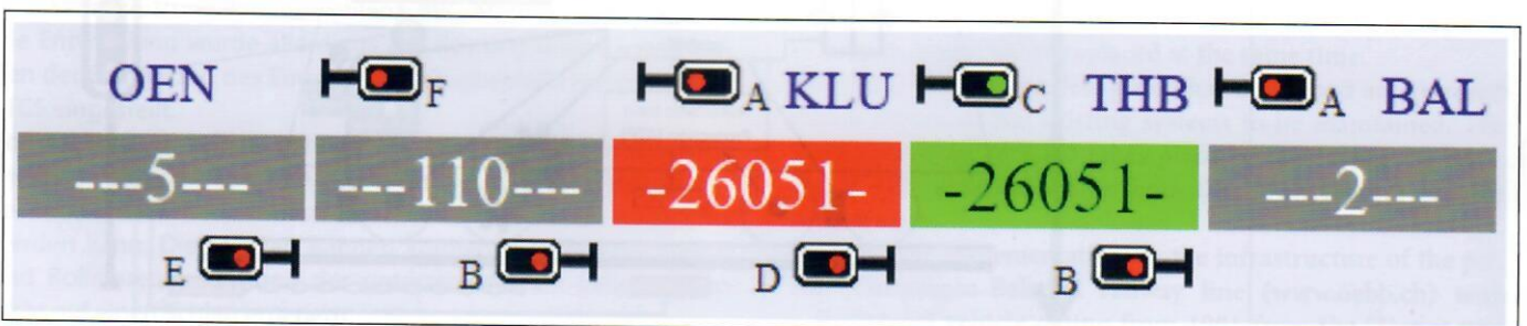
Bild 3: Aus den Signalzuständen abgeleitete Fahrstraßeninformationen
