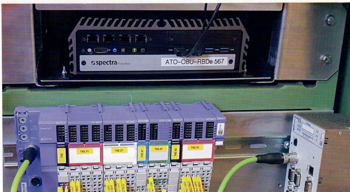
Bild 6: Serie ATO – Rechner und Fahrzeuginterface Fig. 6: Final ATO On-Board Unit and Train-interface Quelle/ Source: RSE
