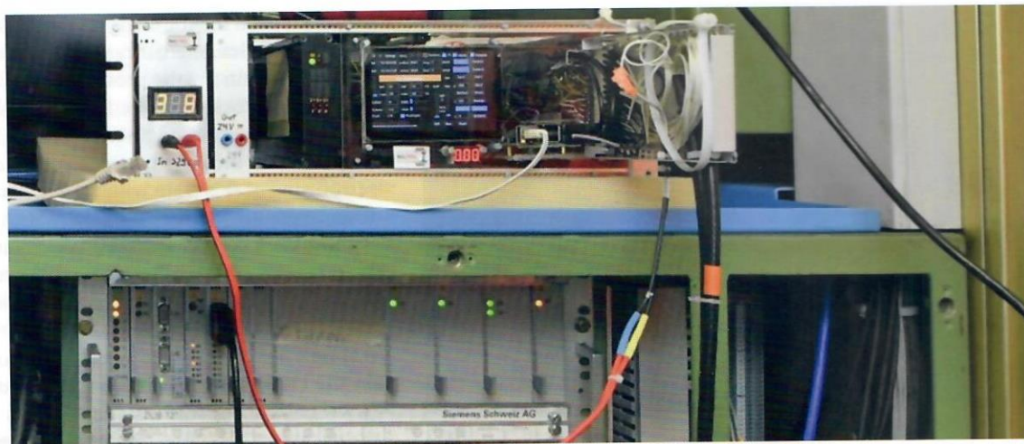
Bild 4: Fahrzeug-interface übersetzt die Befehle des ATO.
